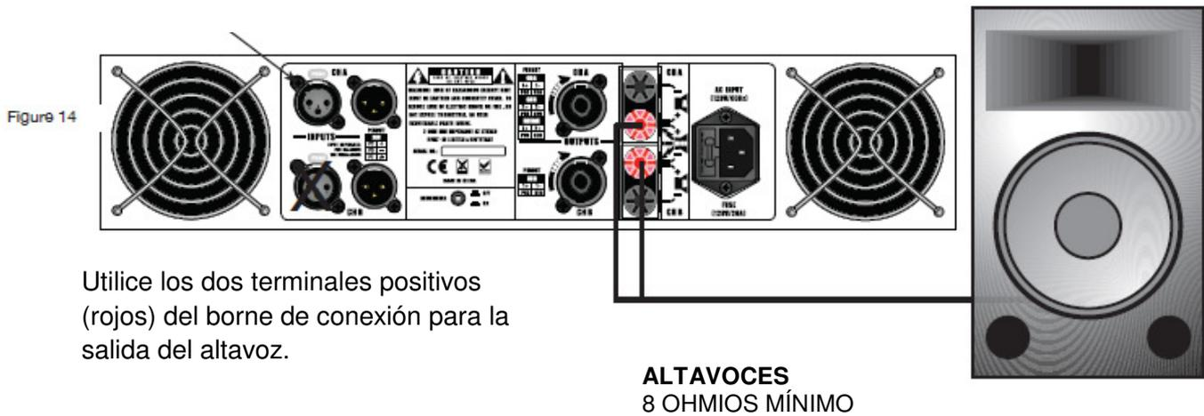
Utilice los dos terminales positivos (rojos) del borne de conexión para la salida del altavoz.
